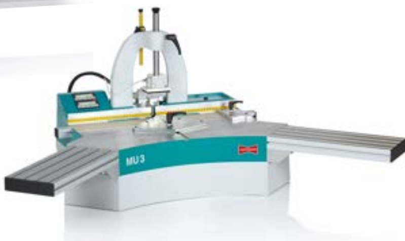
MU-3P Trykluft "sommerfugle" fræser. Elektrisk styret.
